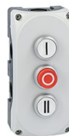
Pulsantiera grigia LPZP2A8 completa con pulsante rasato bianco "i" LPCB1118 1NA, pulsante sporgente rosso "o" LPCB2104 1NC e pulsante rasato bianco "ii" LPCB1128 1NA LPZP3B8905
