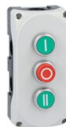
Pulsantiera grigia LPZP2A8 completa con pulsante rasato verde "I" LPCB1113 1NA, pulsante sporgente rosso "O" LPCB2104 1NC e pulsante rasato verde "II" LPCB1123 1NA LPZP3B8903
