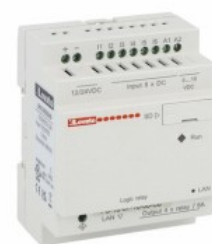
Micro PLC - modulo base con porta Ethernet integrata, senza display LRK12RD024B 12/24VDC 6 digitali + 2 digitali/analogici Nr. 4 relè Nr. 12 (8 inputs + 4 outputs) fino a 36 con moduli LRE
