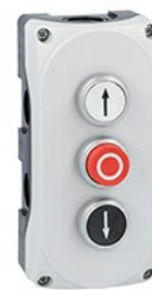
Pulsantiera grigia LPZP3A8 completa con pulsante rasato bianco "freccia su" LPCB1158 1NA, pulsante sporgente rosso "o" LPCB2104 1NC e pulsante rasato nero "freccia giu" LPCB1152 1NA LPZP3B8907
