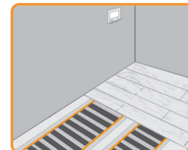
3 - Posa della pavimentazione
