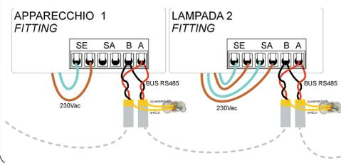
**Cavo bi-polare twistato e schermato**
