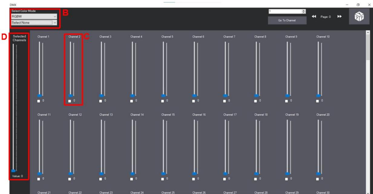
2) Tramite gli slider è possibile controllare i singoli canali da 1 a 512.
