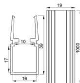
Controcassa - Profilo lineare con passaggio cavo in alluminio 39x18x1000mm per Rubber 3D, Rubber 3D Concrete, Rubber 3D 48V, Rubber 3D Optic, Rubber 3D Pixel
