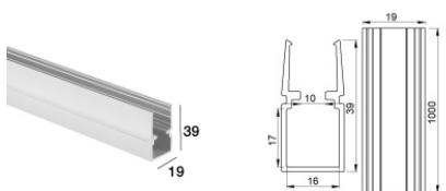
Controcassa - Profilo lineare con passaggio cavo in alluminio 39x18x1000mm per Rubber 3D, Rubber 3D Concrete, Rubber 3D 48V, Rubber 3D Optic, Rubber 3D Pixel
