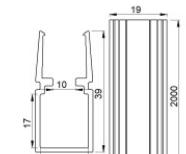
Controcassa - Profilo lineare con passaggio cavo in alluminio 39x18x2000mm per Rubber 3D, Rubber 3D Concrete, Rubber 3D 48V, Rubber 3D Optic, Rubber 3D Pixel
