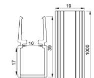
Controcassa - Profilo lineare con passaggio cavo in alluminio 39x18x1000mm per Rubber 3D, Rubber 3D Concrete, Rubber 3D 48V, Rubber 3D Optic, Rubber 3D Pixel
