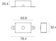
Base per fissaggio - Basetta senza alimentatore
