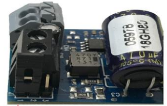
↑ Jumper per selezione della corrente Current selection jumper
