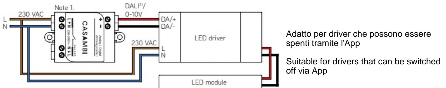
Schema per cablaggio, per driver DALI o 1-10 alimentati da relè esterno
