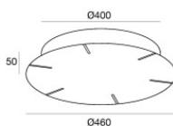
Rosone - Rosone a 6 cavi | 220-240 V AC On-Off Max 150 W + 150 W + 150 W
