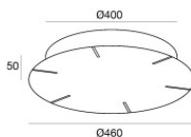
Rosone - Rosone a 6 cavi | 220-240 V AC On-Off Max 150 W + 150 W + 150 W
