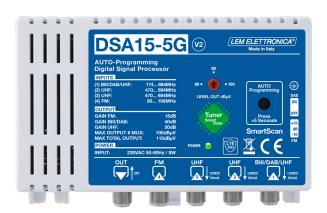
Amplificatore compatto multi-ingresso **DSA15-5G** con tuner integrato per una programmazione completamente autonoma. Il sofisticato algoritmo **SmartScan** riconosce se la modulazione è DVB-T o DVB-T2 e analizzando i dati qualitativi (MER, BER, C/N) sceglie i filtri da attivare per ottenere il maggior numero di canali possibile in uscita. Il livello di uscita viene regolato manualmente in funzione delle caratteristiche dell'impianto di distribuzione.
