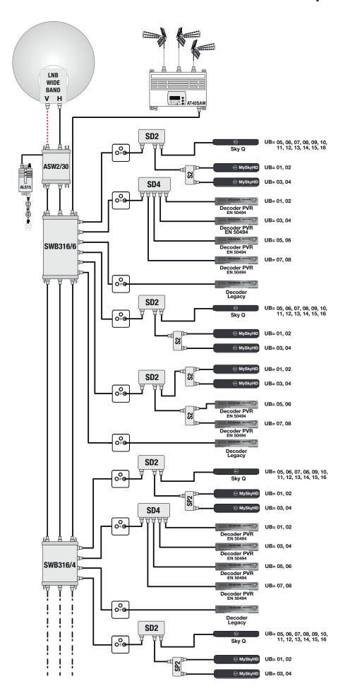
Schema di utlizzo di SWB316 con amplificatore di testa wide band ASW2/30 che amplifica equalizzando i segnali delle 2 montanti satellitari e provvede all'alimentazione dell'LNB. Se in presenza di un elevato numero di decoder collegati alla stessa uscita derivata, per prevenire collisioni tra i messaggi e garantire la compatibilità tra decoder diversi è consigliato l'impiego di smart splitter modello SD2 e **SD4**.
