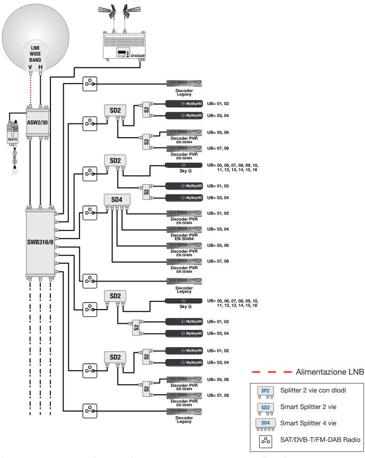
Schema di utlizzo di **SWB316/8** con amplificatore di testa **ASW2/30** che amplifica equalizzando i segnali delle 2 montanti satellitari e provvede all'alimentazione dell'LNB. Se in presenza di un elevato numero di decoder collegati alla stessa uscita derivata, per prevenire collisioni tra i messaggi e garantire la compatibilità tra decoder diversi è consigliato l'impiego di smart splitter modello **SD2** e **SD4**.
