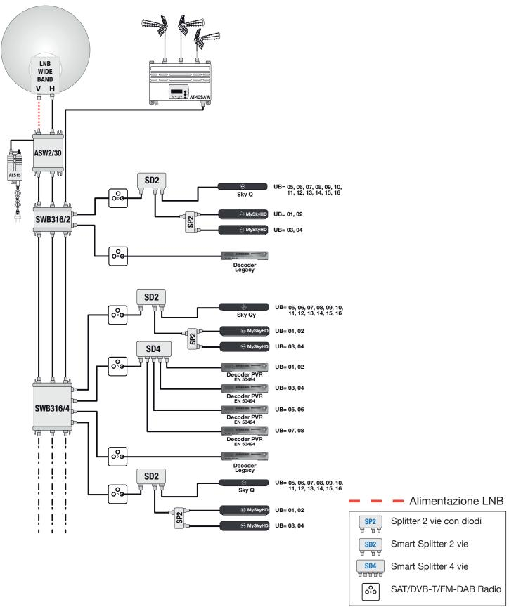
Schema di utlizzo di **SWB316/4** con amplificatore Wide band di testa **ASW2/30** che amplifica equalizzando i segnali delle 2 montanti satellitari e provvede all'alimentazione dell'LNB.
