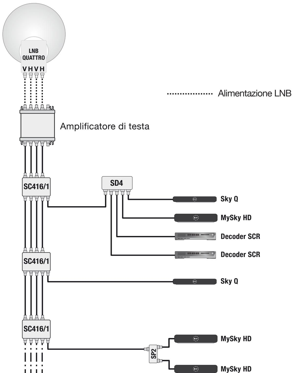
Schema di utilizzo di **SC416/1** con amplificatore di testa che provvede all'alimentazione dell'LNB. I decoder collegati dovranno alimentare solo i multiswitch **dCSS SC416/1**.
