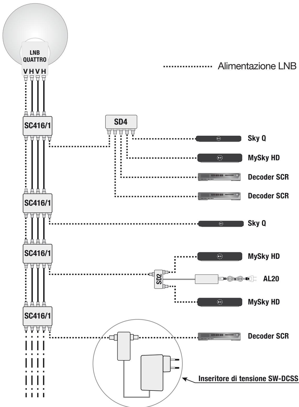
Schema di utilizzo di **SC416/1** che prevede l'alimentazione diretta dell'LNB da decoder. In questo esempio i decoder collegati dovranno sostenere la somma degli assorbimenti in corrente del multiswitch dCSS e dell'LNB. Se la corrente fornita dal o dai decoder non dovesse risultare sufficiente è necessario utilizzare lo specifico kit Inseritore/alimentatore **SW-DCSS** oppure come nell'esempio collegare lo specifico alimentatore **AL20** allo smart splitter tipo **SD4** o **SD2**.
