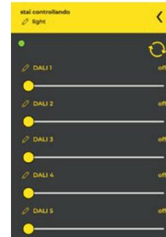
La procedura di indirizzamento dura qualche minuto. Al termine della procedura il dispositivo si disconetterà automaticamente; una volta riconnesso appariranno i dispositivi individuati.
