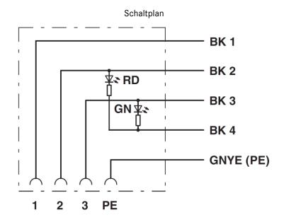
Kontaktbelegung des Ventilsteckers
