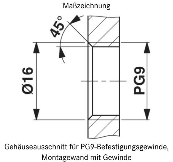
Gehäuseausschnitt für PG9-Befestigungsgewinde, Montagewand mit Gewinde
