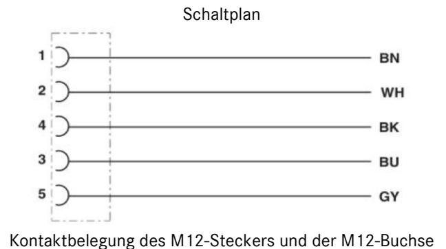
Kontaktbelegung des M12-Steckers und der M12-Buchse
