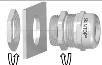
Verschraubung in die Durchgangsbohrung einführen und mit der Gegenmutter festziehen (Anzugsdrehmoment M).
