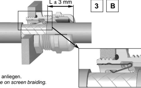
Kabel durch die Verschraubung durchziehen. Die Kontaktfedern müssen an dem Schirmgeflecht anliegen.
