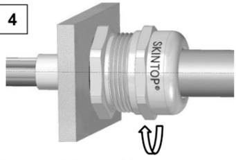
Hutmutter mit dem empfohlenen Anzugsdrehmoment M festziehen.
