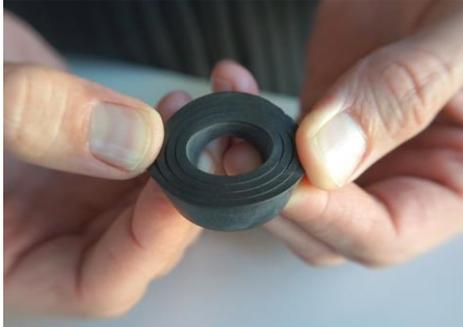
SKINDICHT® Einschnittdichtringe können individuell an gegebene Kabeldurchmesser angepasst werden. Hierfür werden die einzelnen Lagen von innen ausgehend nacheinander mit einem Cutter entfernt.
