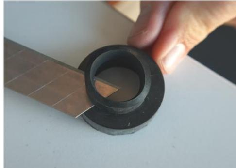
Mit dem Cutter sticht man nun vorsichtig durch den Verbindungsfilm und schneidet langsam im Uhrzeigersinn, bis der Innenring herausgetrennt ist.
