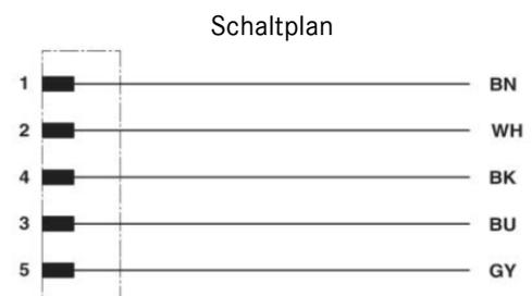
Kontaktbelegung des M12-Steckers und der M12-Buchse
