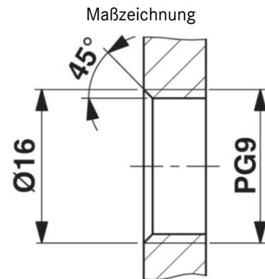
Gehäuseausschnitt für PG9-Befestigungsgewinde,
