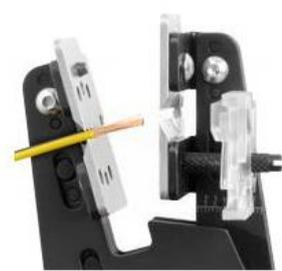
Automatisches Abziehen der Isolation
