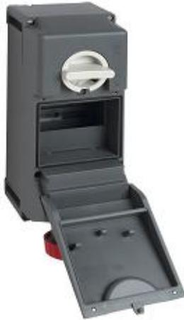
Presca con interruttore di blocco, serie TM, 2 poli + PE, 6 h (blu), 63 A, 200 ÷ 250 V, con vano per apparecchi modulari, 6 moduli guida DIN EN 60715, con scatola base
