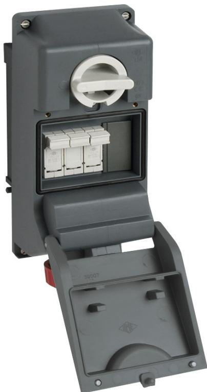
Presa con interruttore di blocco, serie TM, 3 poli + PE, 9 h (blu), 16 A, 200 ÷ 250 V, portafusibile sezionabile 10 x 38 mm, senza scatola base
