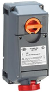
Presa con interruttore di blocco, serie TM ATEX, 3 poli + PE, 6 h (rosso), 16 A, 380 ÷ 415 V, portafusibile sezionabile 10 x 38 mm, con scatola base
