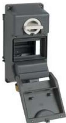
Presa con interruttore di blocco, serie TM, 2 poli + PE, 4 h (giallo), 16 A, 100 ÷ 130 V, con vano per apparecchi modulari, 4,5 moduli guida DIN EN 60715, senza scatola base
