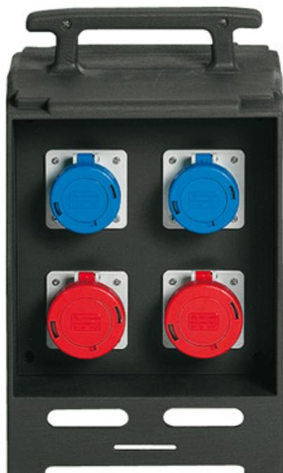
Quadro da cantiere assemblato (ASC), serie Q, con 4 prese PLUSO PEW...PQ/PQF, interruttore magnetotermico 16 A, potenza massima 3 kW
