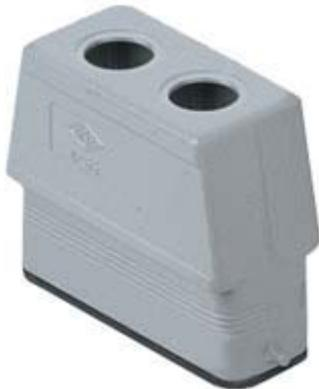
Custodia mobile, serie IL-BRID, con 2 piolini, ingresso cavo M20 x 2 due ingressi cavo verticali senza adattatore, grandezza "66.16", alta
