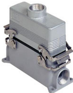
Connettore completo, serie CNZ, composto da 2 frutti con connessione con morsetto a vite 10 poli + PE, e custodia da parete con 2 leve e custodia mobile con ingresso cavo verticale
