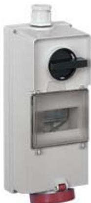
Presca con interruttore di blocco, serie IK, 3 poli + N + PE, 6 h (rosso), 32 A, 200/346 ÷ 240/415 V, con vano per apparecchi modulari, 7 moduli guida DIN EN 60715
