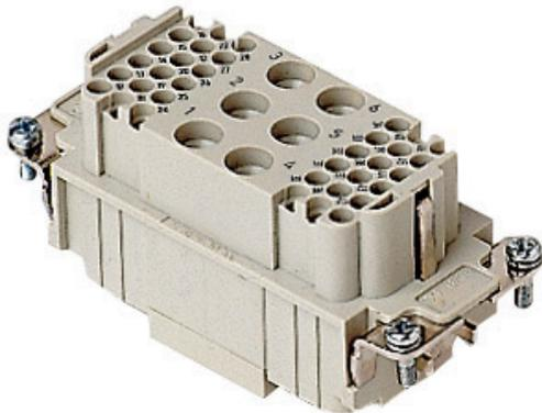
Frutto presa, serie CX, connessione a crimpare, 6 + 36 poli + PE, 40 A 690 V 8 kV 3 / 10 A 160 V 2,5 kV 3, grandezza "77.27"
