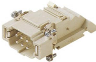
Frutto spina, serie CT, connessione con morsetto a vite, 6 poli + PE, 16 A 230/400 V 4 kV 2, grandezza "44.27", con morsettiera incorporata, montaggio lato destro
