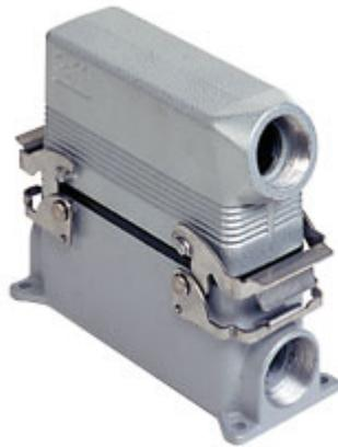
Connettore completo, serie CSZ, composto da 2 frutti con connessione con morsetto a molla 16 poli + PE, e custodia da parete con 2 leve e custodia mobile con ingresso cavo orizzontale
