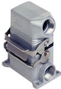
Connettore completo, serie CSZ, composto da 2 frutti con connessione con morsetto a molla 6 poli + PE, e custodia da parete con 1 leva e custodia mobile con ingresso cavo orizzontale
