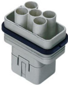
Frutto spina, serie CQ, connessione a crimpare, 4 + 2 poli + PE, 40 A 400/690 V 6 kV 3 / 10 A 250 V 4 kV 3, grandezza "32.13"
