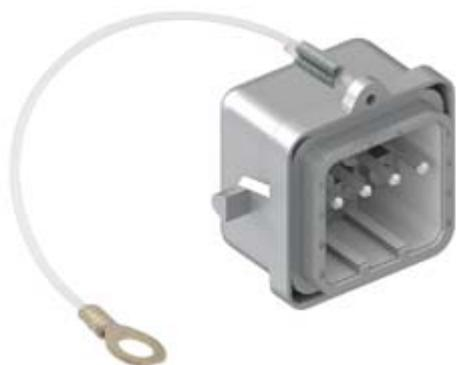
Connettore di terminazione, 4 poli, per frutti CQF 12, con guarnizione e piolini, per collegamento polo 5 con polo 6 e polo 7 con polo 8
