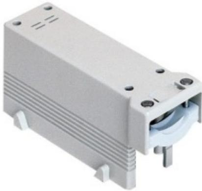
Custodia isolante portafrutti per montaggio mobile, serie COB, ingresso cavo orizzontale con serracavo, per frutti con interasse di fissaggio 44 x 27 mm
