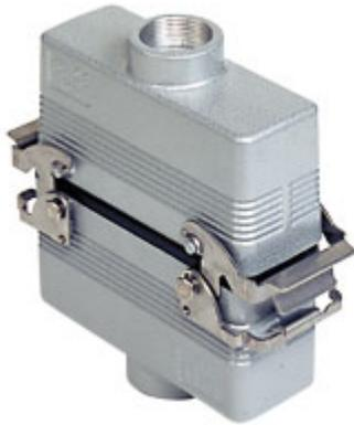
Connettore completo, serie CNZ, composto da 2 frutti con connessione con morsetto a vite 24 poli + PE, e custodie mobili con ingresso cavo verticale e chiusura con 2 leve
