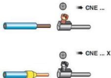
CNE ... X : per conduttori con terminale a bussola
