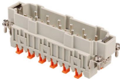
Frutto spina, serie CSMH, connessione rapida con morsetto a molla SQUICH®, 10 + 2 poli + PE, 16 A 830 V 8 kV 3 / 16 A 500 V 6 kV 3, grandezza "104.27"
