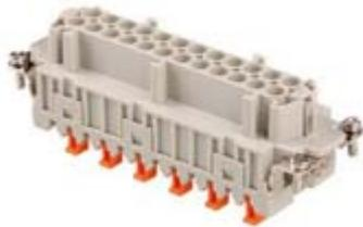
Frutto presa, serie CSMH, connessione rapida con morsetto a molla SQUICH®, 10 + 2 poli + PE, 16 A 830 V 8 kV 3 / 16 A 500 V 6 kV 3, grandezza "104.27"
