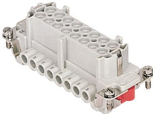
Frutto presa, serie CME, connessione con morsetto a vite, 6 + 2 poli + PE, 16 A 830 V 8 kV 3 / 16 A 500 V 6 kV 3, grandezza "77.27", con piastrina
