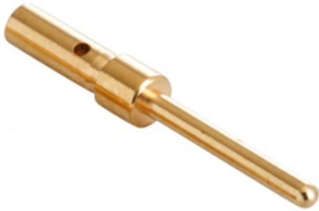
Contatto a crimpare maschio, serie CIV, 5 A, tornito dorato, sezione conduttore 0,2 - 0,52 mm<sup>2</sup>, AWG 24 - 20, per connettori D-SUB
