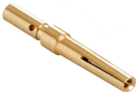
Contatto a crimpare femmina, serie CI, 5 A, tornito dorato, sezione conduttore 0,32 - 0,82 mm<sup>2</sup>, AWG 22 - 18
