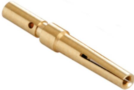
Contatto a crimpare femmina, serie CIV, 5 A, tornito dorato, sezione conduttore 0,2 - 0,52 mm<sup>2</sup>, AWG 24 - 20, per connettori D-SUB
