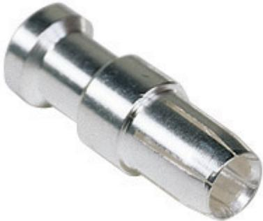
Contatto a crimpare femmina, serie CG, 100 A, tornito argentato, sezione conduttore 35 mm<sup>2</sup>, AWG 2
