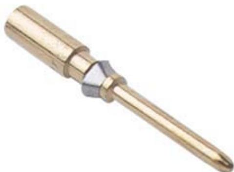
Contatto a crimpare maschio, serie CD, 10 A, tornito dorato, sezione conduttore 1,5 mm<sup>2</sup>, AWG 16, doratura base
